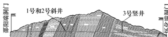
图1 隧道的纵断面
